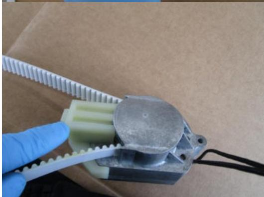
Um den Zahnriemen aus dem Getriebe zu entfernen, muss weitergekurbelt werden, bis der ganze Riemen aus dem Getriebe ist.
