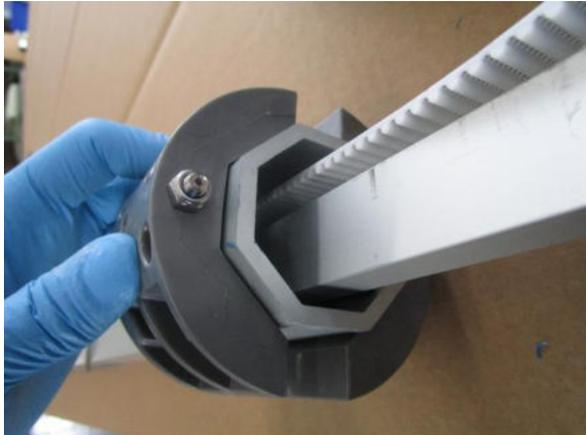
Bei den Stoppmuttern den Innenstock zum Teleskop etwas auf die Seite schieben, damit genug Platz ist um die Muttern zu befestigen.
