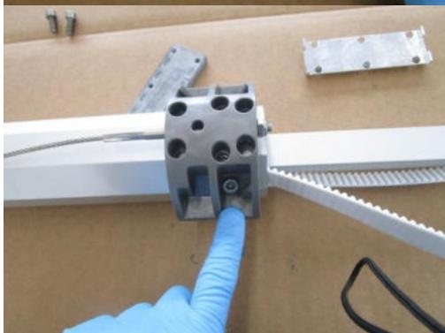
Danach das Teleskop um 90° drehen und die oberen Schrauben sowie das Verdrehlager entfernen.
