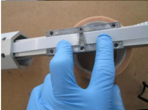
Die beiden Enden vom Zahnriemen in die Platte legen, so dass der mittlere Spalt der Platte frei bleibt.
